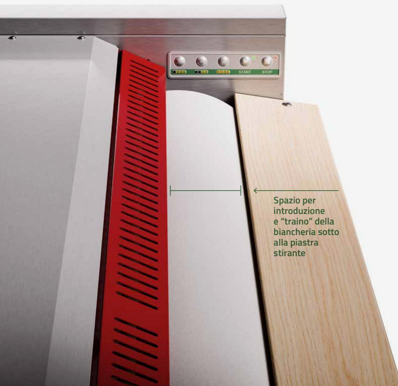
Ogni dettaglio delle nuove **stiratrici GI** è stato studiato per fornire all'operatore la posizione di lavoro più comoda. Come l'innovativo **Adjustable Infeed Plate (AIP)**, l'asse d'introduzione della biancheria in legno, regolabile in varie inclinazioni, che evita il surriscaldamento e qualsiasi carica eletrostatica.
