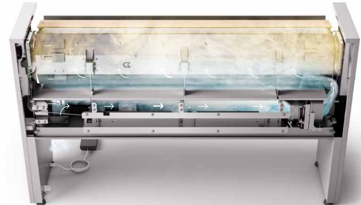
Le **stiratrici GI**, inoltre, sono dotate di un sistema di raffreddamento della banda salvadita, **Finger-guard Cooling System (FCS)**, e di 2 sensori di temperatura che, in caso di surriscaldamento rilevato dalla scheda elettronica, interviene spegnendo il sistema di riscaldamento. Un **doppio sistema di attivazione del riscaldamento**, poi, con due contattori, fa sì che in caso di guasto la macchina sia sempre in sicurezza.
